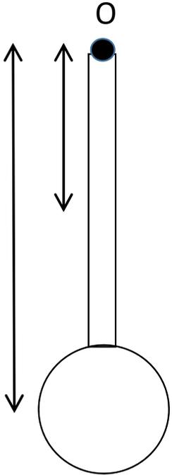
$$I_O^{\text{Péndulo}} = I_O^{\text{Disco}} + I_O^{\text{Barra}}$$
